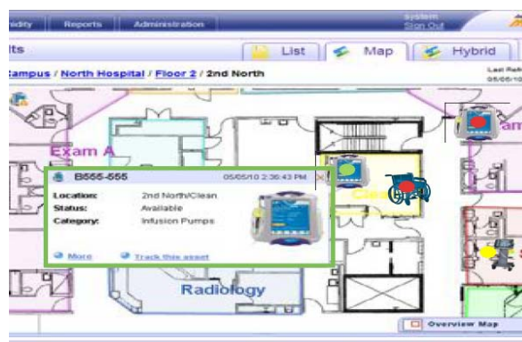
図 2 無線 LAN を利用した資産管理
