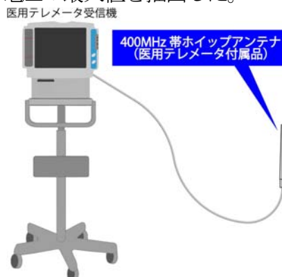
図1.医用テレメータによる放射妨害波発生源の特定方法
