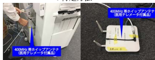
図2.医用テレメータの簡易スペアナ機能を利用した放射妨害波発生源の特定法
