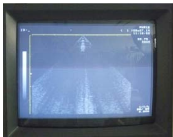
図 7 超音波診断装置への雑音混入 (コンベックスプローブ)
