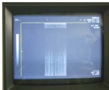
図 6 超音波診断装置への雑音混入 (リニアプローブ)
