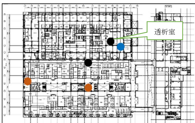
図 5 稼働後 12 階携帯電話基地局電波強度の測定結果
