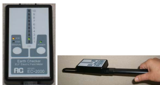
図 2 簡易電磁界測定装置 (左:表示画面、右:使用方法)
