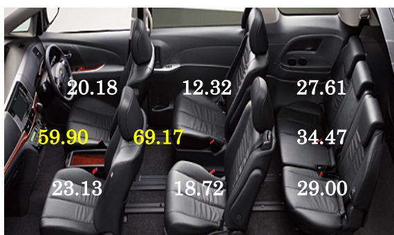
図 3 トヨタエスティマ車内の キーレス機能使用時の電波強度 (単位：dBμV、黄色字：アンテナ搭載位置)
